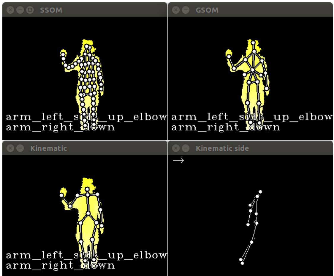
Abbildung 3.8.: Programm zum Testen des Verfahrens über das Netzwerk. Das Programm erhält vom Verfahren das aktuelle Tiefenbild, die Topologien von SSOM, GSOM und dem kinematischen Modell sowie für beide Arme die erkannte Geste. Alle Modelle werden zusammen mit dem Tiefenbild visualisiert, das kinematische Modell wird zusätzlich in einer Seitenansicht gezeigt.
